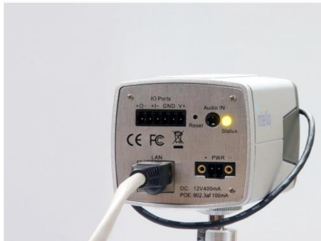
A státusz LED zöld, a kamera meg van táplálva és van IP címe
